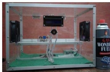
Gambar 6. Perancangan Letak Sensor Dan Dudukan Arduino
